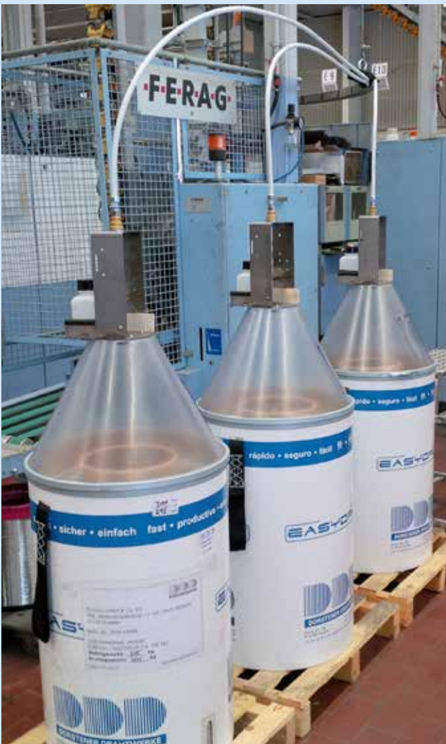
Oben: Sicherheitsheftung mit Dorstener Heftdraht Links: EASYDRUM™-System für Inline-Heftung
