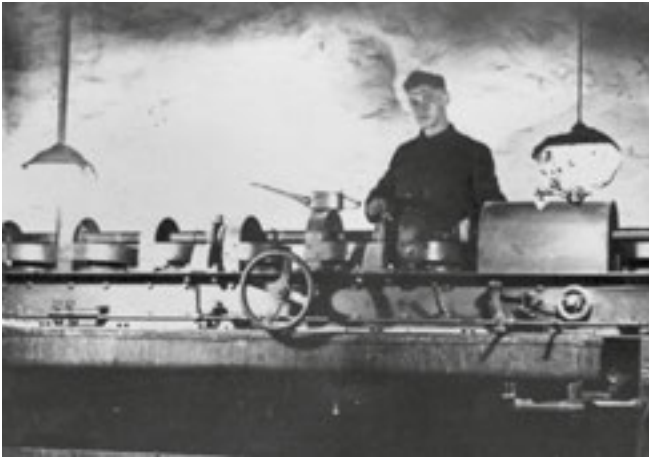
Feinzug: Breitenbach-Maschine mit Ziehsteinen, 1932
